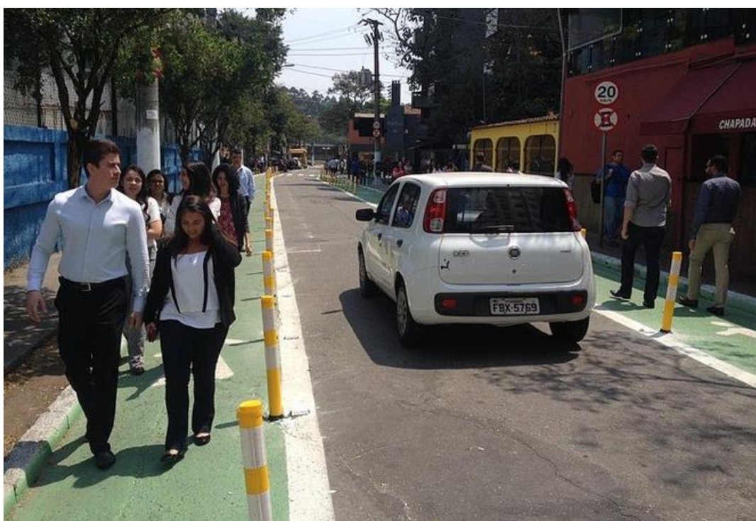
Figura 28: Balizadores separando os pedestres dos veículos.
