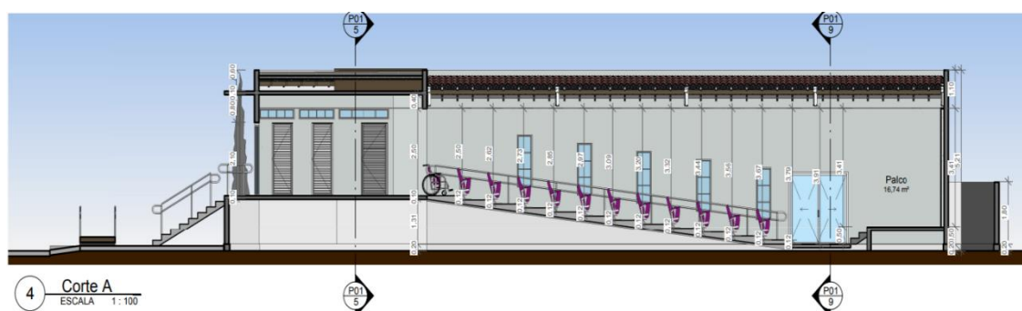
Figura 11 - Corte Longitudinal do Auditório
