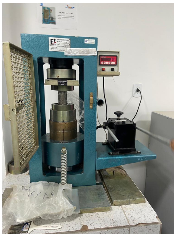
Figura 10: Prensa de ensaio de determinação da resistência a compressão
